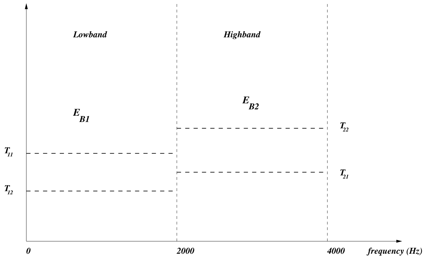
Fig. 4 EVRC VAD Thresholding Mechanism
